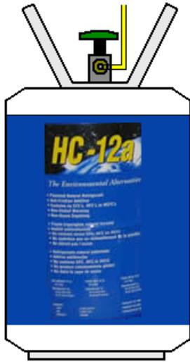
Según las tablas de burbujeo del HC 12 a, a una presión de 34.8 psia (recordemos que es una presión absoluta NO manométrica), la temperatura de saturación es 15 °F (-9.4 °C).
